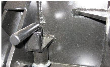
Fig. 9 Position déverrouillée
