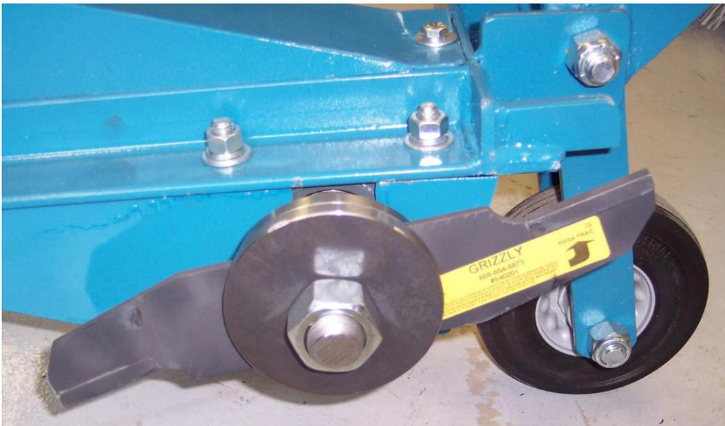
S'assurer que l'écrou de 1" est suffisamment serré pour empêcher la lame de débarquer. Ne jamais opérer la mini coupeuse avec une lame tordue, brisée ou endommagée. Ceci pourrait causer des vibrations et faire éclater et projeter la lame, ce qui entraînerait possiblement des dommages matériels ou des blessures graves.
