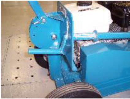
Fig. 4 Levier d'ajustement en position de repos
