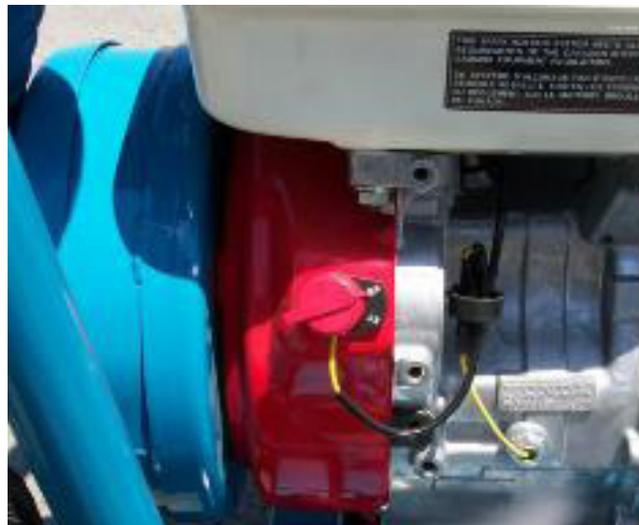
Fig. 6 Interrupteur
