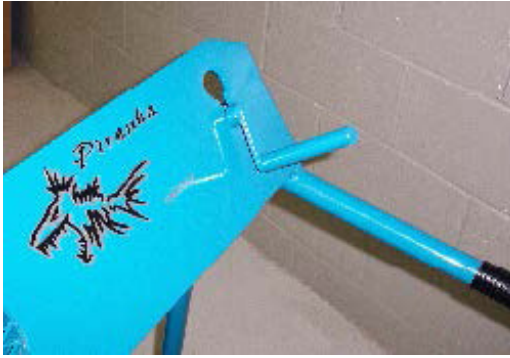
Fig.4 Levier d'ajustement en position de repos
