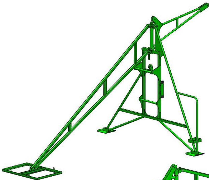
Monte-charge pivotant permettant de ramener la charge au dessus du toit en faisant pivoter le mat.
